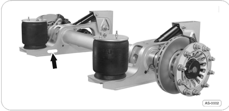
Şek. 2 · INTRA Tipi, Havalı Süspansiyon Sistemlerinde tip etiketinin pozisyonu
